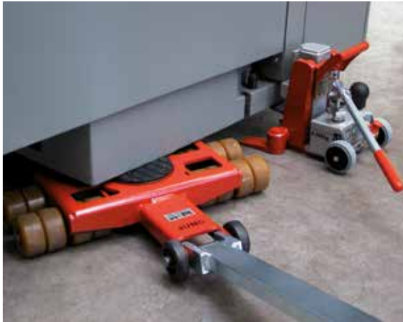
Wielen met kogellagering garanderen een lagere rolweerstand
