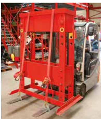
Ladingbeveiliging met heftruckklemmen en trekbanden
